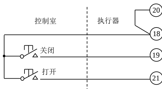
图 9-2 保持式打开/关闭控制，行程可逆，但不能停在中途位置
