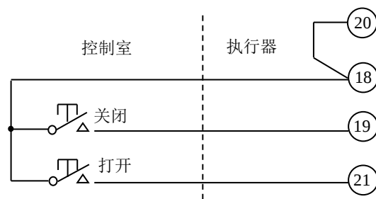
图 9-2 保持式打开/关闭控制，行程可逆，但不能停在中途位置
