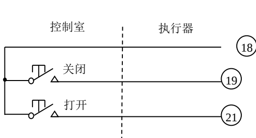
图 9-1 点动式打开/关闭控制，执行器可以停在中途任意位置
