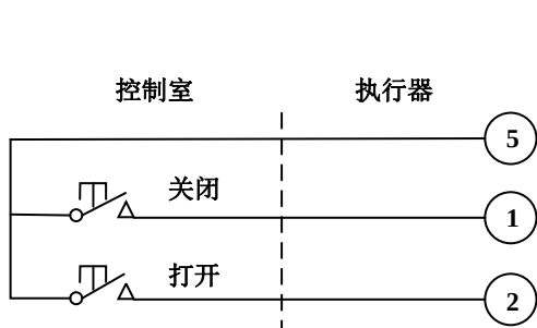
图 9-1 点动式打开/关闭控制，执行器可以停在中途任意位置
