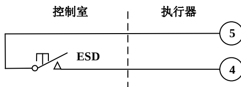
图 9-3 ESD 控制（内部供电）
