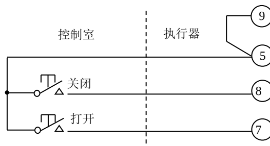
图 8-2 保持式打开/关闭控制，行程可逆，但不能停在中途位置
